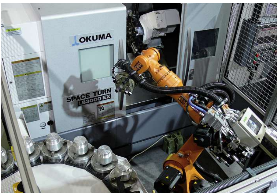
Bild 1: In der automatisierten Zelle wird die Drehmaschine vom Roboter bestückt.
