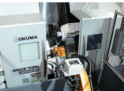
Bild 4: Der Roboter be- und entlädt die Werkzeugmaschine.
