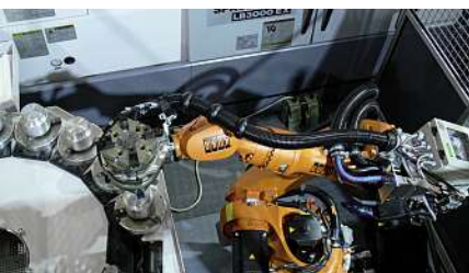
Bild 3: Vom Rundtaktspeicher nimmt der Knickarmroboter die Bauteile.
