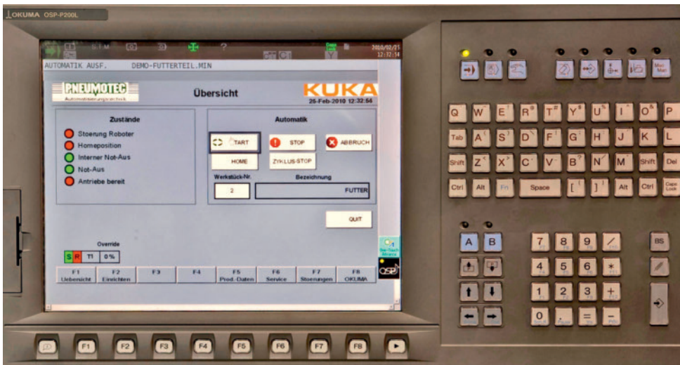
2 Einheitliche Bedienkonsole: Auf den Okuma-OSP-P200-Steuerungen laufen unabhängig von den Maschinenprozessen gängige Windows-Programme, so kann auch die Kuka-Robotersteuerung direkt an der Maschinen-CNC visualisiert und durch Eingabe weniger Parameter programmiert werden
